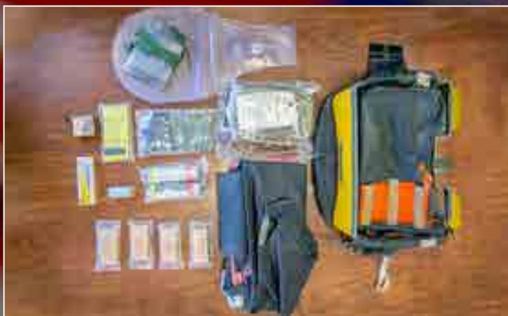
si articoli necessari alla sopravvivenza del pilota per tutto il periodo necessario all'intervento dei soccorsi: un battellino monoposto che può essere utilizzato nel caso di ammaraggio del pilota dopo l'eiezione; un dissalatore ad osmosi che gli consentirà di
